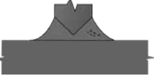
31 Porosity in Fillet (sub-surface) UT, RT
