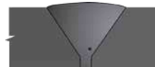
39 Porosity in Fillet (sub-surface) UT, RT
